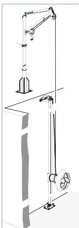
**Установка на направляющей шине**
