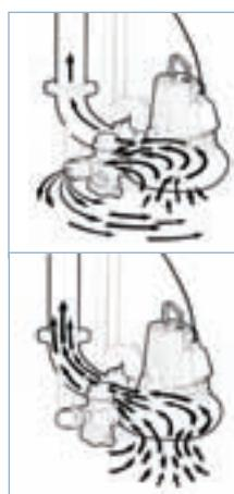
Клапан промывки превращает насос в мощную мешалку. После пуска насоса клапан открывается приблизительно на 30 секунд, и мощная струя смыгает все твердые субстанции, возвращая их во взвешенное состояние в жидкости. Поскольку последовательность промывки является частью цикла работы насоса, промывка происходит каждый раз при пуске насоса.
