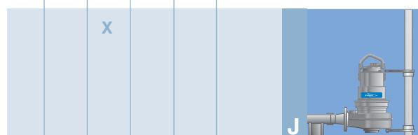
Полупостоянная установка с поворотной направляющей шиной для перемешивания и перекачивания жидкости.
