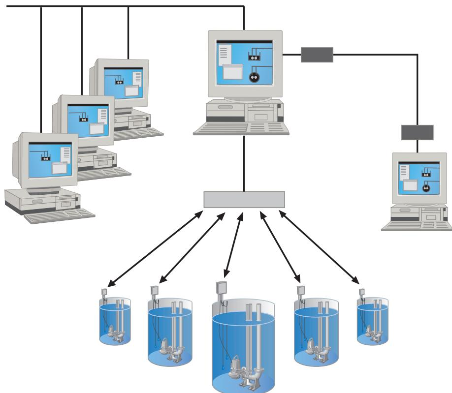
С помощью контроллера, обеспечивающего все стандартные рабочие операции по перекачке, эти устройства предоставляют дополнительное управление в широком спектре применений для транспортировки сточных вод. Систему FMC можно использовать совместно с пакетом программ AquaView для повышения мощности и универсальности ее применения с целью обеспечения контроля и управления оборудованием в системе пользователя.
