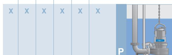
Полупостоянная установка в мокром колодце. Насос устанавливается с помощью двух направляющих шин на выпускном соединении.
