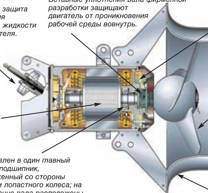
Уплотнение корпуса обеспечивается разделительной жидкостью. Она также обеспечивает смазку и охлаждение уплотнений.
