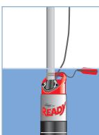
В вертикальном положении в бетонном насосном колодце с реле уровня жидкости.
