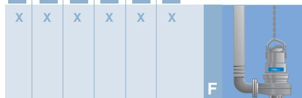
Полупостоянная установка в свободно стоящем положении. Исполнение с возможностью перемещения с трубопроводным или шланговым соединением.
