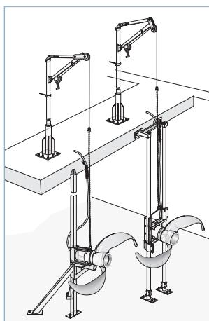
Установка с одной или двумя направляющими шинами
